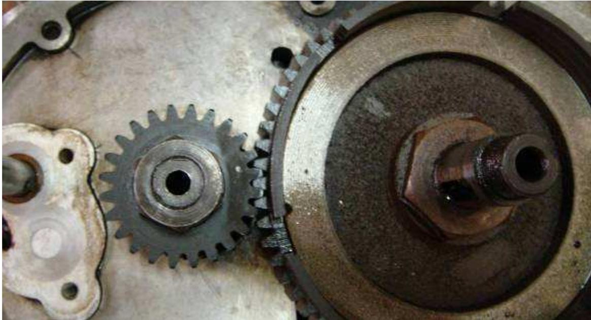
**Step 3/** Retour au PMH du step 1 en tournant dans le sens inverse moteur (horaire vu coté gauche)
