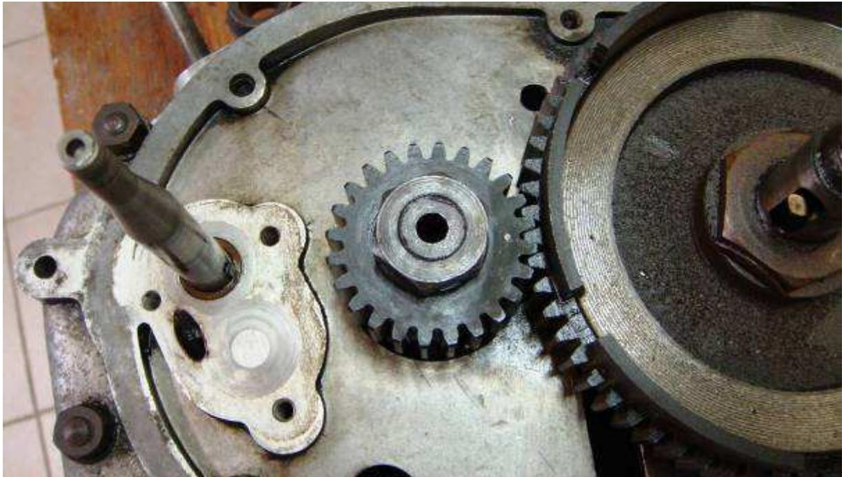
**Step 2/** Tourner le moteur dans le sens fonctionnement (antihoraire vu du coté gauche) jusqu'à ce que le poussoir d'échappement soit en fin de course (rétracté au max). le poussoir échappement est celui qui est sur l'arrière droit. A ce point précis c'est la fin de came d'échappement => repérage sur le pignon moteur. Le décalage est de 1 dent par rapport au PMH.
